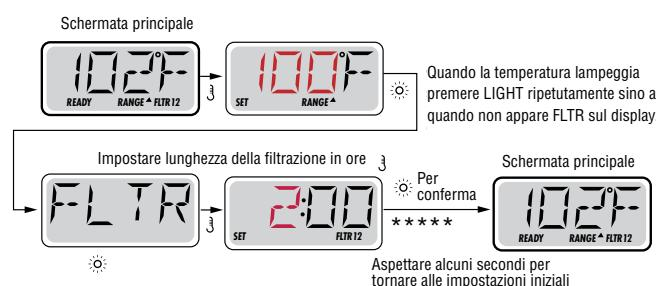
Se il ciclo di filtrazione 2 è attivato, sullo schermo appare Filter 12.
