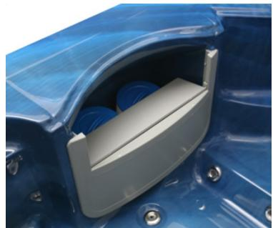
Ogni 2 mesi o meno il filtro deve essere pulito per togliere le particelle che si trovano nelle pieghe del filtro. Usare un tubo dell'acqua con getto pressurizzato dall'interno verso l'esterno delle pieghe del filtro. Se il filtro è troppo sporco per essere pulito come sopra descritto, chiedere al proprio rivenditore. Il filtro può durare diversi anni se pulito correttamente.
