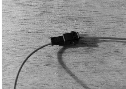
(3) Collegare il connettore del sensore di temperatura.
